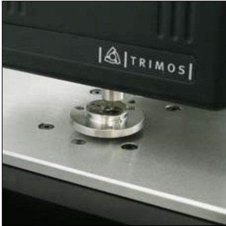
Mesure de texture d'une surface polie miroir
