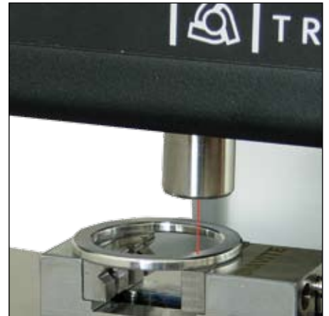
Positionnement aisé et précis de la mesure grâce au pointeur laser
